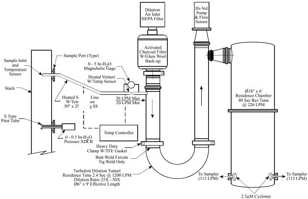
Figure 2-5. DRI Dilution Sampler (Chow et al, 2004).
