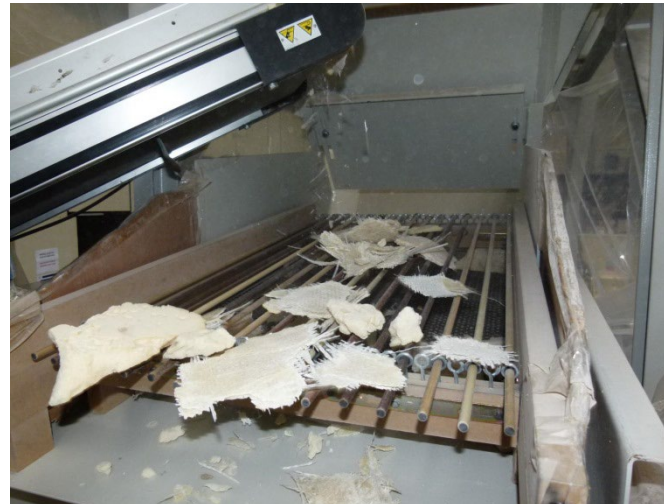
Cut GFRP composite waste Image: BRIO project / Elhuyar Fundazioa
