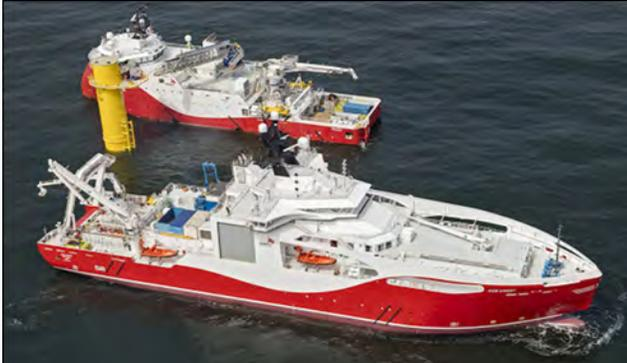
**Figure 39. Array-Cable Installation** (Courtesy, Nordsee Ost Windfarm).
